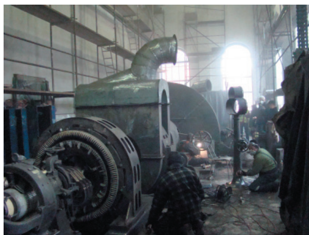
Wałbrzych. Park Wielokulturowy Stara Kopalnia – spotkanie z przetwornicą w trakcie konserwacji prowadzonej przez PUB Robert Zimny
