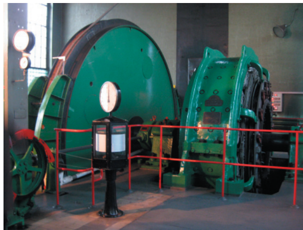
Szyb Łokietek – maszyna wyciągowa
