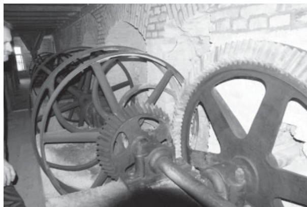
Główny wał napędowy urządzeń młyńskich
