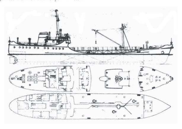
Na zbiornikowcach do przewozu wody pitnej konstrukcja zbiorników jest odmienna od rozwiązań stosowanych na zbiornikowcach, służących np. do przewozu ropy naftowej i paliw płynnych. Ładunek jest oddzielony od wody zaburtowej podwójnym dnem i podwójnymi burtami. Statek posiada 4 zbiorniki ładunkowe przedzielone w płaszczyźnie
