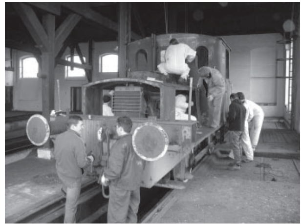
Demontaż osłon silnika Ls40
