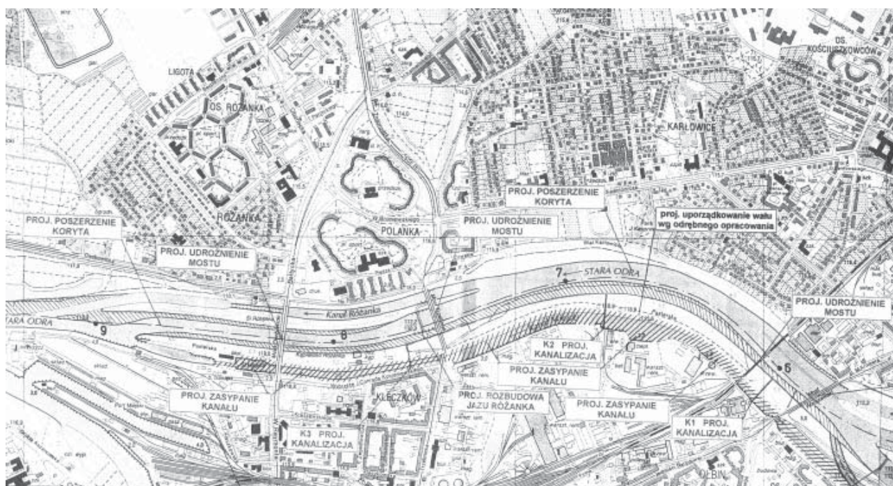
Plany przebudowy kanału miejskiego
