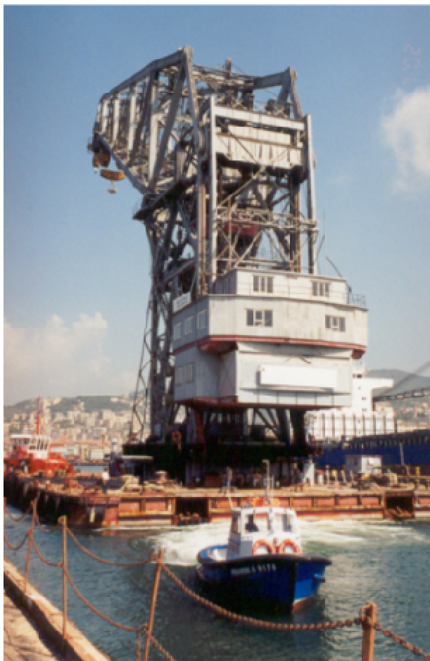
Dźwig pływający Heimricj i jego siłownia energetyczna z silnikami Diesla
